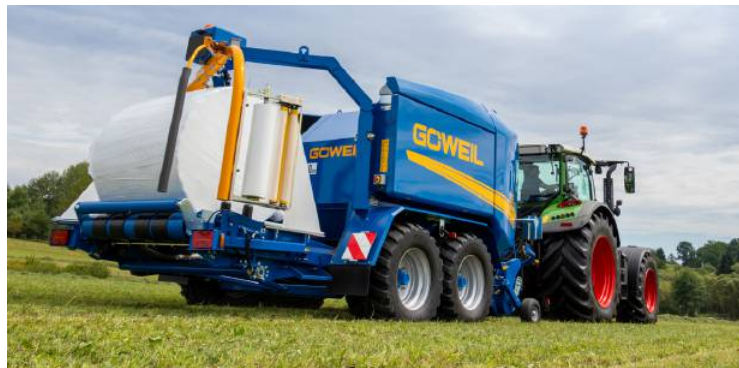
Mit der G-1 F125 Kombi werden die Arbeitsschritte Pressen und Wickeln in einer Maschine kombiniert – so ist wirtschaftliches Arbeiten möglich. Foto: Göweil
