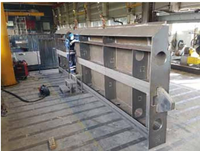
Fertigung des neuen Schützen für die Schotterschleuse
